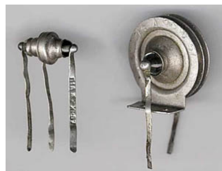
Первые отечественные транзисторы. П1А и ПЗА (с радиатором). 1957 год.
